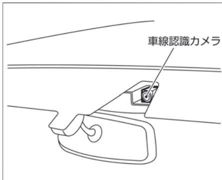
LDP（車線逸脱防止支援システム）は、車速が約70km/h以上で走行車線の右側もしくは左側のレーンマーカーに近づいたときに、警報とともにダイレクトアダプティブステアリング（P.114）の機能を用いて車両を車線内に戻す方向に制御力を短時間発生させることで、運転者が自車を車線内に戻す操作を促すシステムです。
