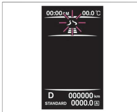
エマージェンシーブレーキは、前方の車両と衝突のおそれがあるとき、警報と自動ブレーキにより、運転者の衝突回避操作を支援します。
