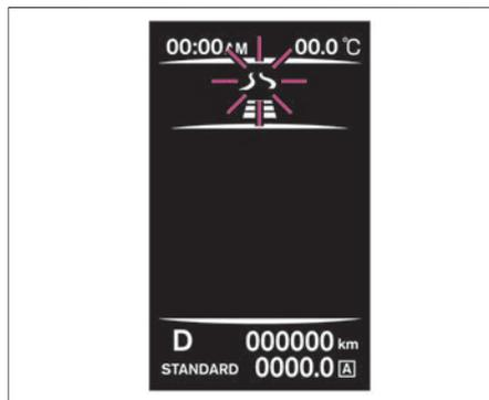
定速制御機能を使用すると、セレクトレバーがDまたはマニュアルモードのとき、アクセルペダルを踏まなくても、一定の速度で走行することができます。
