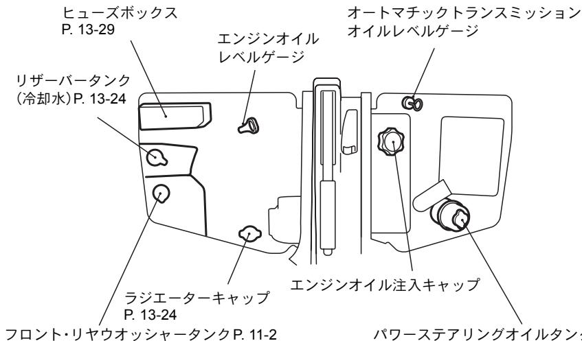
・エンジンルームの点検は、シートを操作して行います。→「エンジン点検口」P. 4-14
