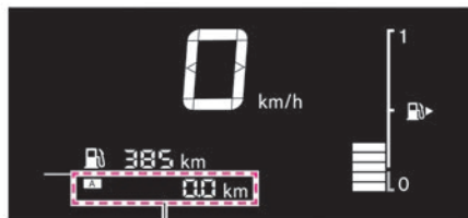
オドメーター (積算距離計) / トリップメーター (区間距離計)
