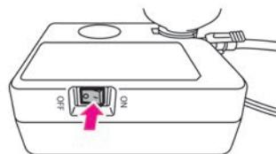
5 指定空気圧まで昇圧できたら、コンプレッサーのスイッチをOFF（「○」の位置）にし、電源プラグを電源ソケットから抜きます。
