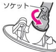
3 古い電球を引き抜き、新しい電球をソケットに取り付けます。
