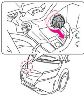
**2** 古い電球を引き抜き、新しい電球をソケットに取り付けます。
