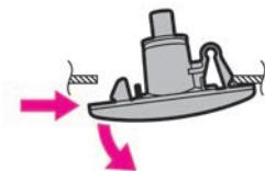
2 ソケットを矢印の方向に回して引き抜きます。
