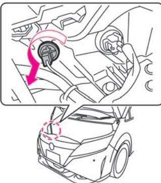
2 古い電球を引き抜き、新しい電球をソケットに取り付けます。
