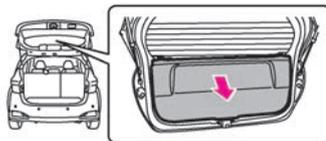
3 ソケットを矢印の方向に回して引き抜きます。
