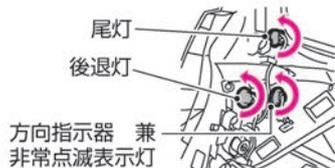
4 古い電球を引き抜き、新しい電球をソケットに取り付けます。
