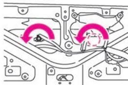
4 古い電球を引き抜き、新しい電球をソケットに取り付けます。
