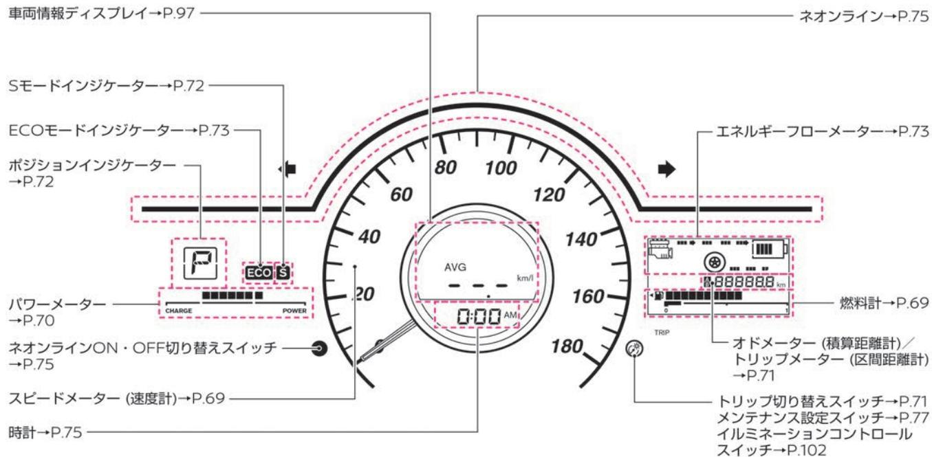
メーターには、スピードメーター（速度計）、パワーメーター、ポジションインジケーターなどがあります。パワースイッチをON にすると表示します。
