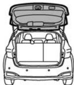
2 リヤコンビランプのボルトを外し、ランプをまっすぐ後方に引いて取り外します。
