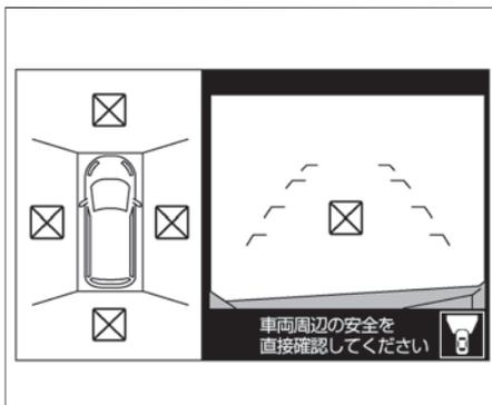
車速約10km/h以下で前進中または後退中にソナーが障害物を検知した場合は、警報音でお知らせします。
