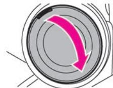
3 ソケットを矢印の方向に回して引き抜きます。
