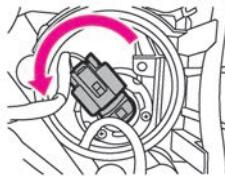
4 コネクターを取り外し、電球を交換します。
