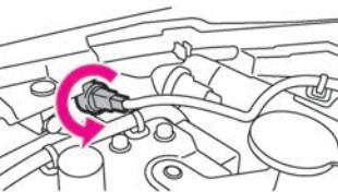
2 古い電球を引き抜き、新しい電球をソケットに取り付けます。
