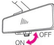
3 インテリジェント ルームミラーモードに切り替わり、モニターに車両後方の画像が表示されます。
