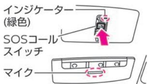
4 SOSコールサービスのオペレーターと通話します。状況に応じてオペレーターからの折り返し、もしくは公共機関（警察・消防・医療機関）からの通話着信があります。着信時は自動で音声接続します。通話が終了したら、カバーを戻し、ロックするまで押します。
