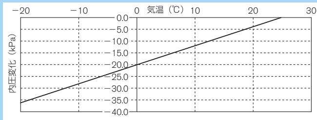
※1 常温（25°C）で測定、調整したタイヤ内圧の外気温変化によるタイヤ内圧（窒素）変化量の一例を示しています。
