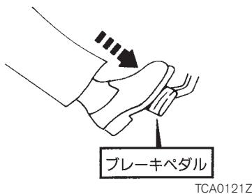
②ABSが作動すると、ブレーキペダルに振動が伝わったり、作動音が聞こえたりします。これはABSの正常な作動によるものです。そのままブレーキペダルを踏み続けてください。
