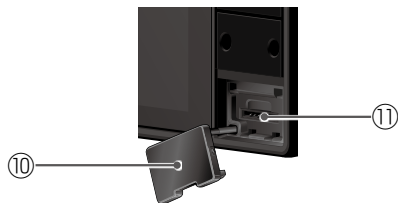
microSD カード挿入口カバーを開けた状態
