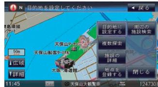
施設を中心とした地図が表示されますので、位置を確認して [目的地に設定する] ボタンをタッチします。
