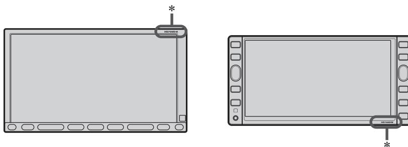
\*印：ご使用のナビゲーション本体の型式を確認してください。型式(HS709D-A／HS709D-W／HS309-A／HS309-W)によって機能の有無が異なります。
