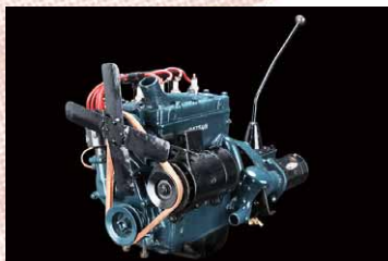
<7型>ベンジャミンを参考に開発され1935年ダットサン14型に搭載。主運動部の軽量化など現代にも繋がる先進的な設計思想が見られる
