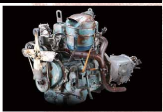
<P型>グラハムベイツの水冷L6サイドバルブエンジンを祖とし1959年にOHV化し680型トラック等への搭載でデビュー <C型>過酷な使用条件でも壊れない信頼性を重視し、オースチンのIH型をベースに開発。1958年に生産開始
