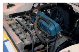
エンジンはTSレースに準じたチューニングのA12型。ソレックスのキャブレターが純粋なレーシングカーの証だ
