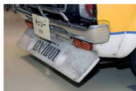
フロントスポイラーは板状の筋索な形状となっている。ロゴの左右にはブレーキへ空気を導入するダクトが開く
