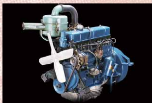
<P型>グラハムベイツの水冷L6サイドバルブエンジンを祖とし1959年にOHV化し680型トラック等への搭載でデビュー <C型>過酷な使用条件でも壊れない信頼性を重視し、オースチンのIH型をベースに開発。1958年に生産開始
