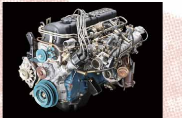
<L型(6気筒)>プリンス、トヨタの6気筒に対抗し約9ヶ月で開発。写真のL20ET型は1979年に日本初のターボエンジンとして登場し、その後のターボ時代の幕開けを飾った
