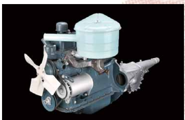
<G型>オースチン国産化の経緯を活かした戦後初の日産独自開発エンジンで1960年セドリック30型に搭載された
