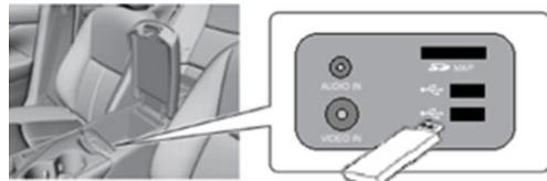
※USBメモリの挿入口は車種により異なります。「ナビゲーションシステム 取扱説明書」よりご確認ください。
