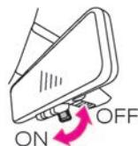
3 インテリジェント ルームミラーモードに切り替わり、モニターに車両後方の画像が表示されます。
