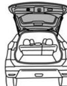
2 お手持ちの工具でリヤコンビランプ上部にあるサイドspoイラーのボルトを外し、サイドspoイラー本体を取り外します。
