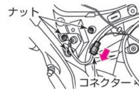
4 交換したい電球のソケットを矢印の方向に回して引き抜きます。
