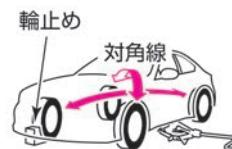
3 ジャッキを手で回し、ジャッキの溝がジャッキアップポイントの中央に入るまで上げます。
