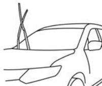
4 元に戻すときは、ワイパー アームを倒してから、電源ポジションをONにし、ワイパーを1回作動させます。
