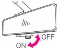
3 スマート・ルームミラーモードに切り替わり、モニターに車両後方の画像が表示されます。
