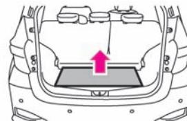
3 工具が収納されているボードを取り外します。
