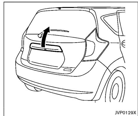
次のいずれかの操作で解錠後、バックドアハンドルを引きます。
