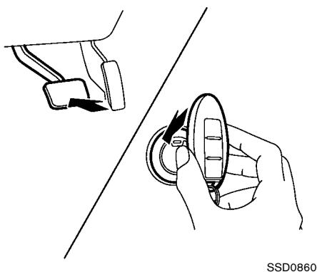
インテリジェントキーの電池が切れたときや、使用環境によりインテリジェントキーと車両の通信が正常に行われないときには、次の手順でエンジンを始動してください。
