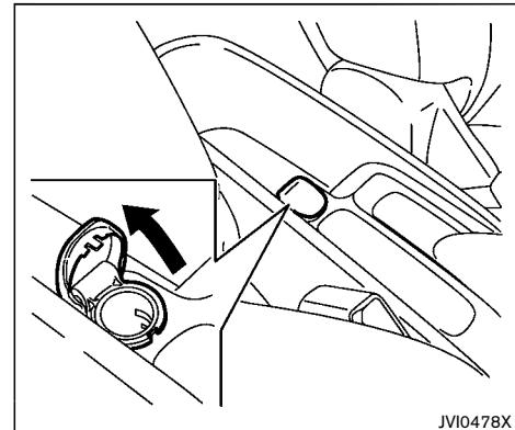
カーアクセサリーの電源をとるときや、市販の車載電話および携帯電話の車載キットの電源をとるときに使います。
