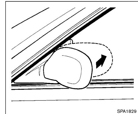
ミラー本体の外端を車両後方に押すと倒れます。
