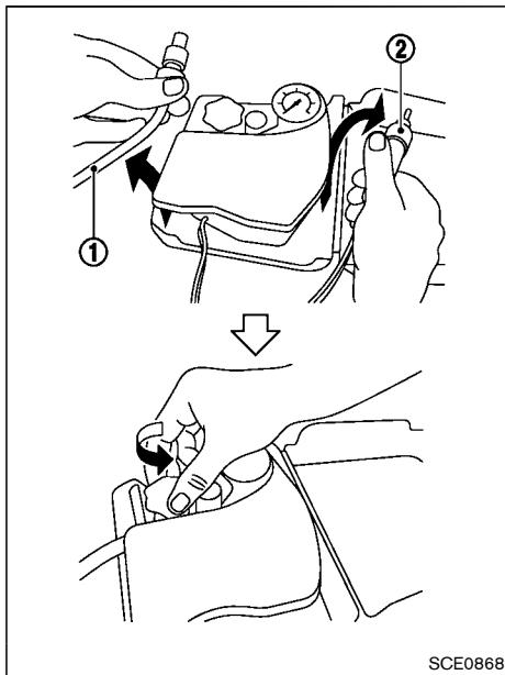
2. エアコンプレッサーからホース①と電源プラグ②を取り出します。エアコンプレッサーからボトルホルダーのキャップを外します。
