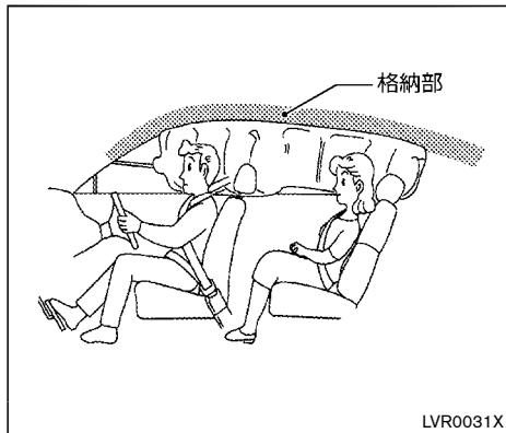
車両側面から強い衝撃を受けたとき、衝撃を受けた側のSRSカーテンエアバッグが瞬時に膨らみ、乗員の主に頭部にかかる衝撃を緩和するシステムです。
