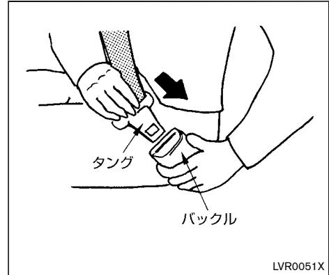
3. ベルトがねじれないようにして、タングをバックルに“カチッ”と音がするまで確実に差し込みます。
