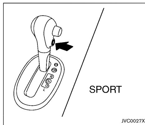
スポーツモードをONにするときは、セレクトレバーを **D** に入れてスポーツモードスイッチを押します。メーターのSPORT表示灯 **SPORT** が点灯します。スポーツモードをOFFにするには、もう一度スポーツモードスイッチを押します。セレクトレバーを **D** 以外に
