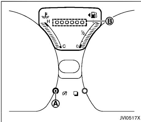
キースイッチ（電源ポジション）がONのときにメーター照明の明るさを調節できます。
