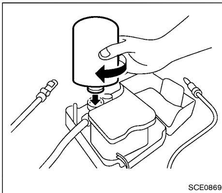
3. 修理剤ボトルのキャップを外し、内ぶたをつけたままボトルホルダーに取り付けます。（ボトルホルダーにねじ込むと、内ぶたが破れます。）
