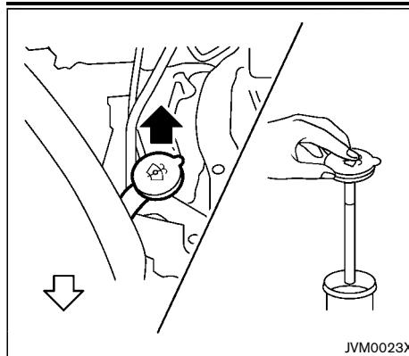
ウォッシャー液が不足しているときは、ウォッシャータンクのキャップを外し、ウォッシャー液を補給してください。ウォッシャー液容器に記載してある凍結温度を参考に、外気温に応じた希釈割合（濃度）にして補給します。
