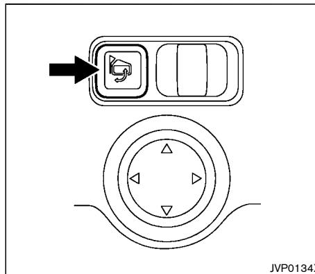
キースイッチ（電源ポジション）がACCまたはONのときに作動します。
