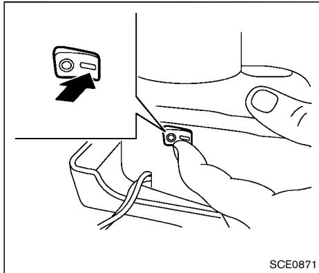
6. 電源ポジションをACCにしてコンプレッサーのスイッチをON (-)位置にし、タイヤを指定空気圧または最低180kPaまで昇圧します。
