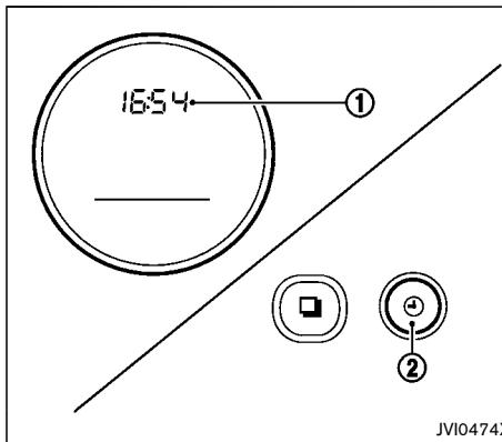
時計①は、キースイッチ（電源ポジション）がONのときに表示されます。
