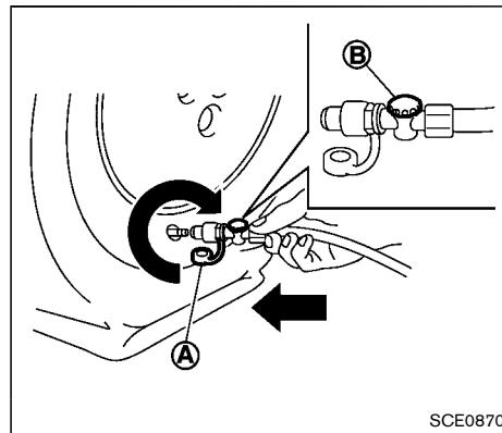
5. ホース先端の保護キャップⒶを外し、ホース（排気バルブⒷがしまっていることを確認してください）をタイヤのバルブに確実にねじ込みます。コンプレッサーのスイッチがOFF(O)位置にあることを確認し、電源プラグを車内の電源ソケットに差し込みます。
