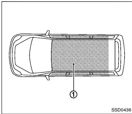
インテリジェントキーがイラストの作動範囲内①にあるときだけ、インテリジェントキー機能を使用してエンジンを始動できます。
