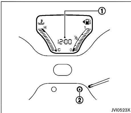
時計①は、キースイッチ（電源ポジション）をONのときに表示されます。時刻を調整するには、次の手順に従ってください。
