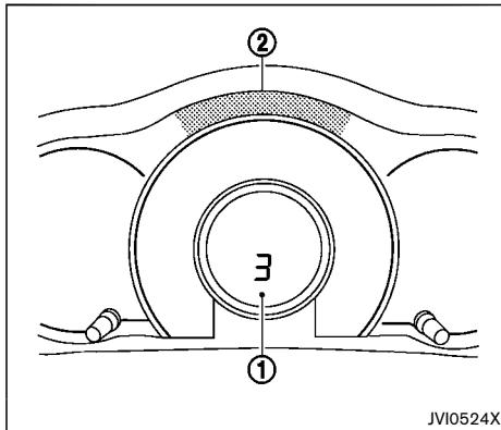
走行中（キースイッチ（電源ポジション）をONにしてからOFFにするまで）にエコドライブができていたかを運転後に評価します。
