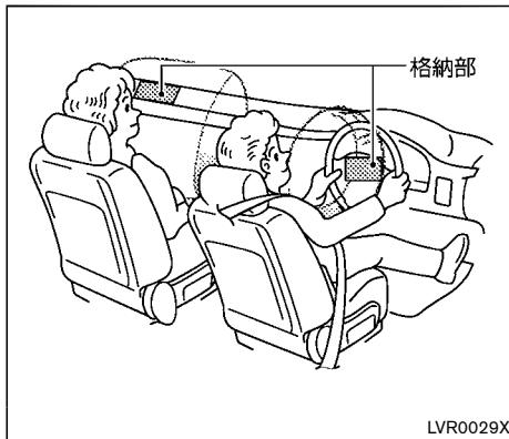
車両前方から強い衝撃を受けたときSRSエアバッグが瞬時に膨らみ、乗員の頭部にかかる衝撃を緩和するシステムです。
