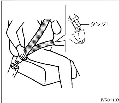
3. ベルトがねじれないようにして、タング1をバックル1に“カチッ”と音がするまで確実に差し込みます。
