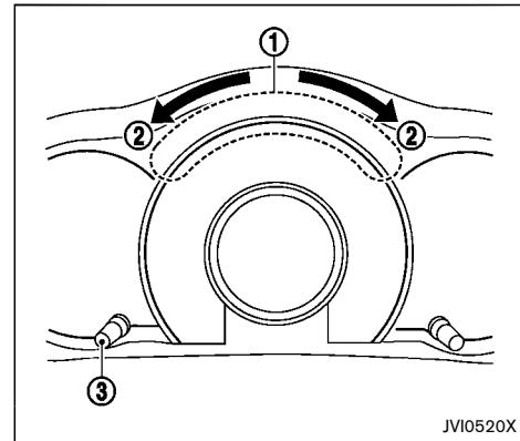
ECOモードで走行中、アクセルペダル操作に応じてエコドライブインジケーター①が3段階で点灯します。（セレクトレバーがⒷのときは、点灯しません。）
