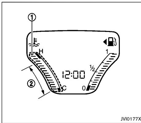
水温計①はエンジン冷却水の温度を表示します。
