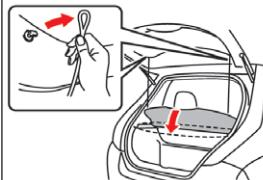
2 トノカバーを引き上げ、トノカバーホルダーを受け軸から取り外します。
