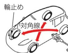
3 ジャッキを手で回し、ジャッキの溝がジャッキアップポイントの中央に入るまで上げます。
