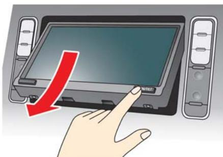
“ピピッ”と音が鳴り、モニターの角度が変わります。指を離すごとに、1段ずつモニターの角度が変わります。
